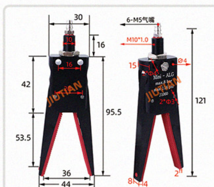
Mini-DLG外牙 夹取范围 0-36mm
